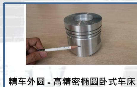
精车外圆 - 高精密椭圆卧式车床
