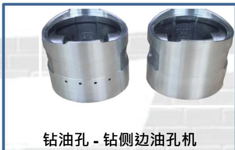
钻油孔 - 钻侧边油孔机
