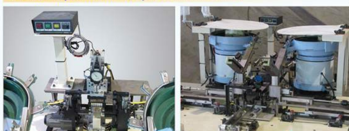
◆偏擺檢測 Runout tester ◆銅套組入 Copper bush press fit
