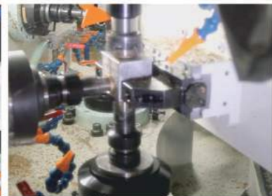
三方向主軸 Tri-direction spindles
